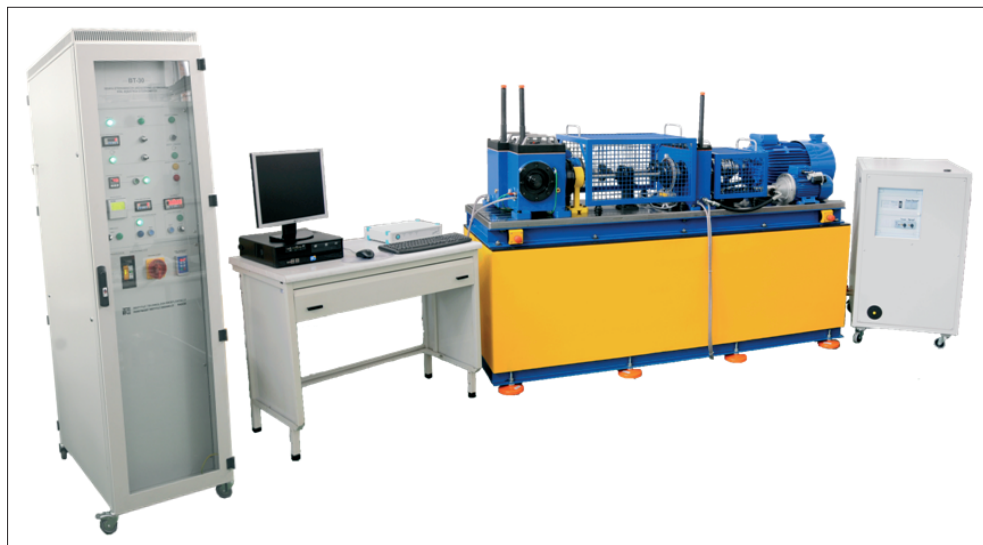
Rys. 2. Zdjęcie urządzenia do badania kół zębatych stożkowych, z systemem sterująco-pomiarowym (po lewej stronie) oraz wymiennikiem ciepła (po prawej stronie)
