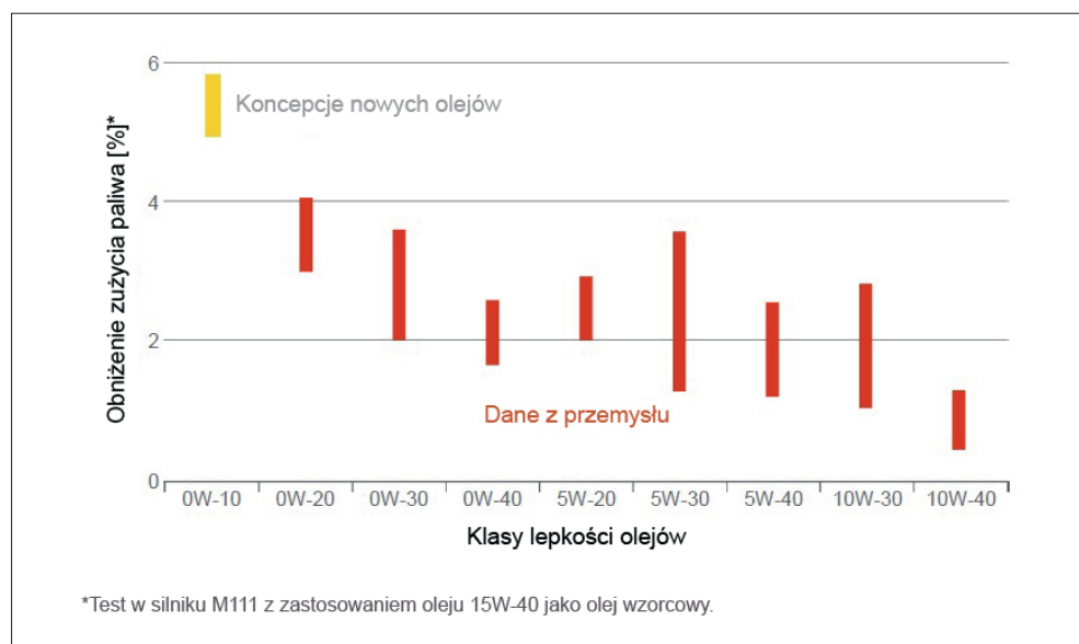
Rys. 4. Wyniki badań olejów silnikowych różnych klas lepkości w teście M111 [16]
