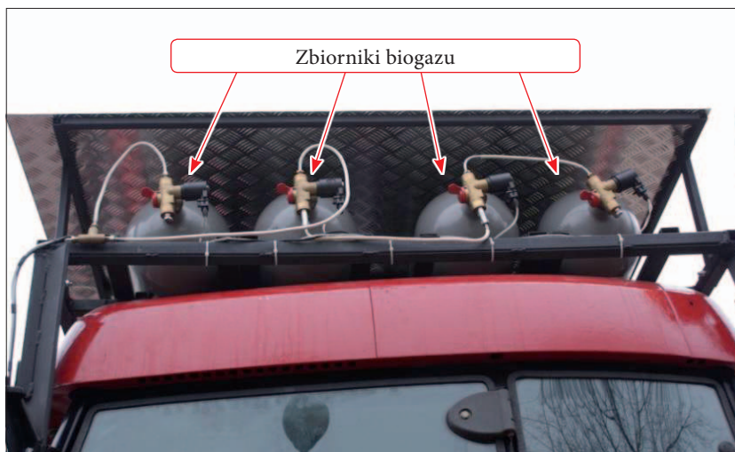
Rys. 2. Widok zbiorników biogazu zainstalowanych na dachu ciągnika Case IH
