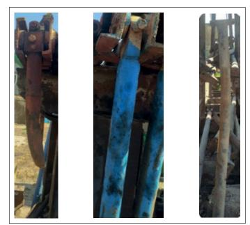
**Figure 7.** Deformation and fracture of connecting rods **Rysunek 7.** Odkształcenie i spękanie żerdzi łączących
