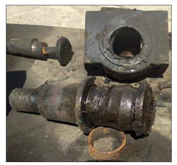
Figure 10. Connecting rod pin wear Rysunek 10. Zużycie trzpienia żerdzi łączącej
