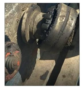
Figure 5. Damaged crank support due to vibrations Rysunek 5. Podpora korby uszkodzona z powodu drgań
