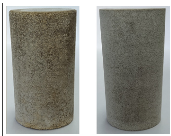
Rysunek 2. Wybrane próbki rdzeniowe wycięte do badań geomechanicznych: z lewej próbka 2, z prawej próbka 4
