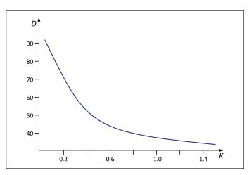
Figure 1. Influence of slurry on core permeability Rysunek 1. Wpływ zawiesiny na przepuszczalność rdzenia
