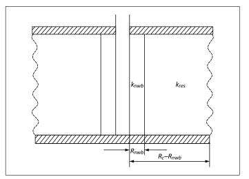
Figure 4. Scheme of oil inflow to the well, taking into account the damage of the bottomhole formation zone during the opening **Rysunek 4.** Schemat przypływu ropy do odwiertu, uwzględniając uszkodzenie formacji w strefie dennej w czasie udostępniania
