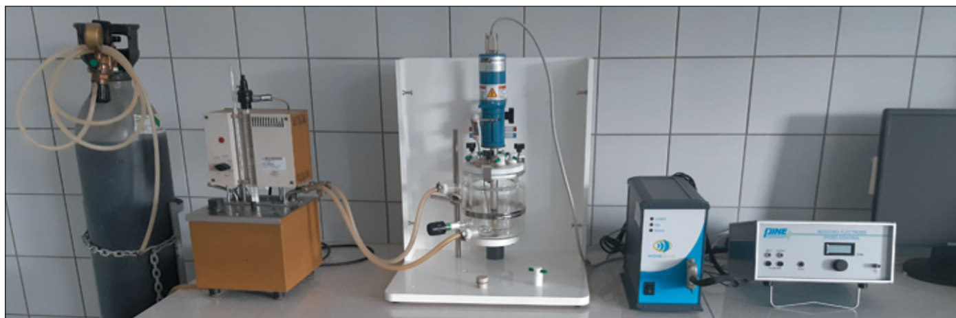
Rysunek 11. Stanowisko do badań korozyjnych aparatem RCE
