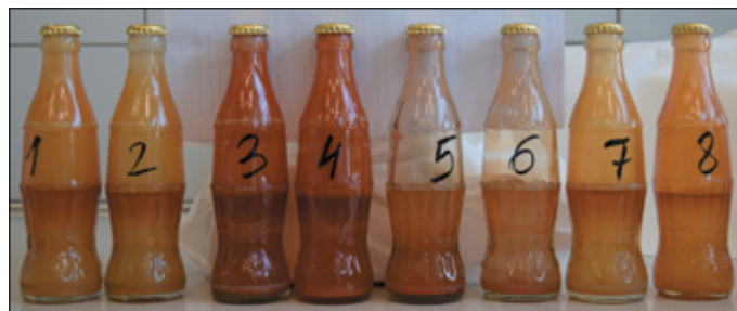
Rysunek 10. Wygląd butelek po wykonaniu badań korozyjnych Wheel Test
