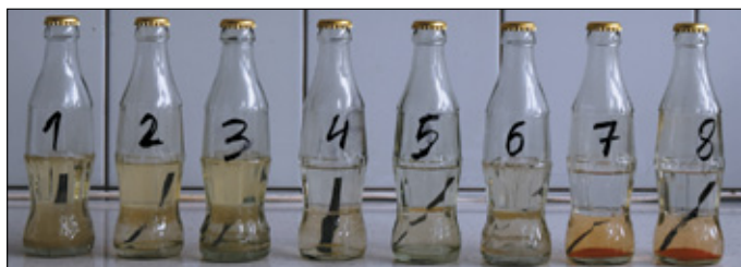
Rysunek 8. Wygląd i przygotowanie butelek przed rozpoczęciem badań korozyjnych Wheel Test
