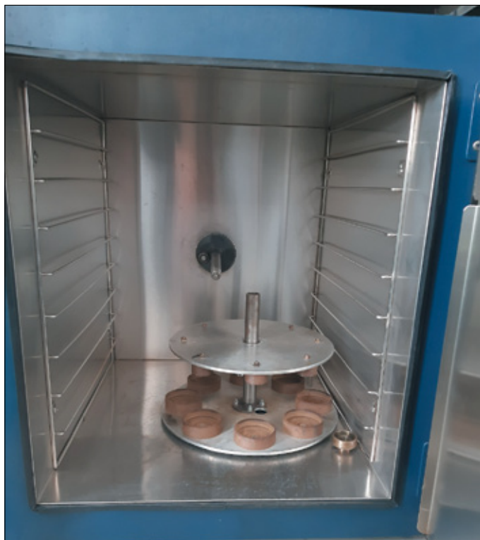
Rysunek 7. Stanowisko do badań korozyjnych Wheel Test według NACE ID182-2005
