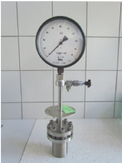
Fig. 4. Instrument for oxidation resistance determination acc. to PN-C-04143 (photo INiG – PIB) Rys. 4. Aparat do oznaczania odporności na utlenianie według PN-C-04143 (fot. INIG – PIB)
