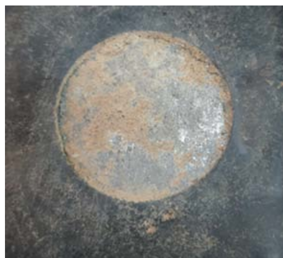
Rys. 10. Elektroda symulująca po oczyszczeniu (fot. T. Minor)
