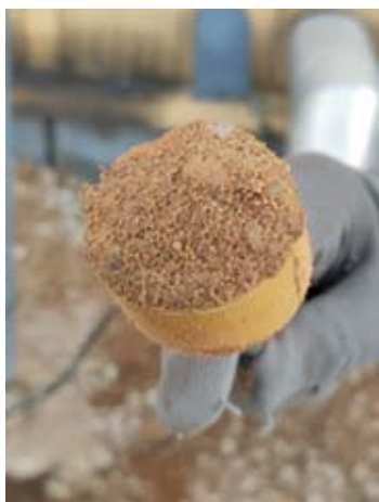
Rys. 5. Elektroda symulująca pokryta produktami katodowymi, zdemontowana w punkcie D (fot. T. Minor)
