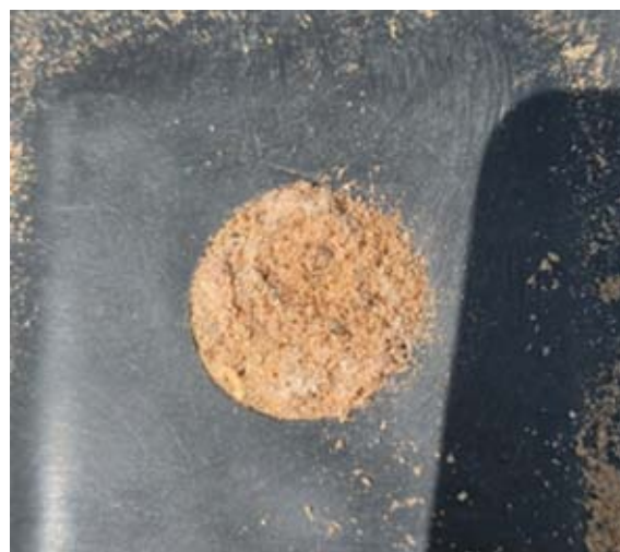
Rys. 9. Elektroda symulująca pokryta osadami katodowymi (fot. T. Minor)
