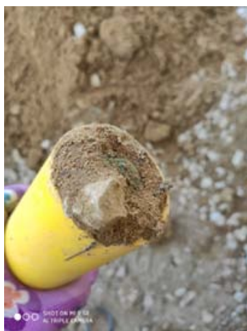
Rys. 3. Elektroda symulująca zintegrowana z elektrodą odniesienia pokryta produktami katodowymi, zdemontowana w punkcie D (fot. T. Minor)
