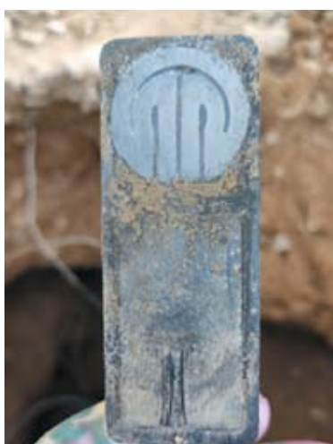
Rys. 7. Czujnik korozymetryczny po oczyszczeniu, zdemontowany w punkcie D (fot. T. Minor)
