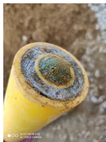
Rys. 4. Elektroda symulująca zintegrowana z elektrodą odniesienia po oczyszczeniu z produktów katodowych, zdemontowana w punkcie D (fot. T. Minor)
