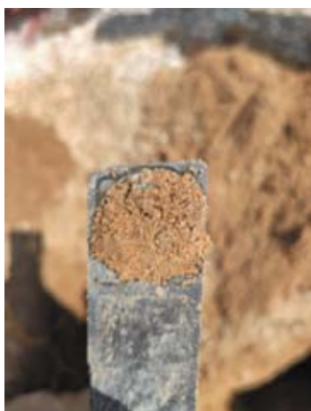
Rys. 6. Czujnik korozymetryczny zdemontowany w punkcie D (fot. T. Minor)
