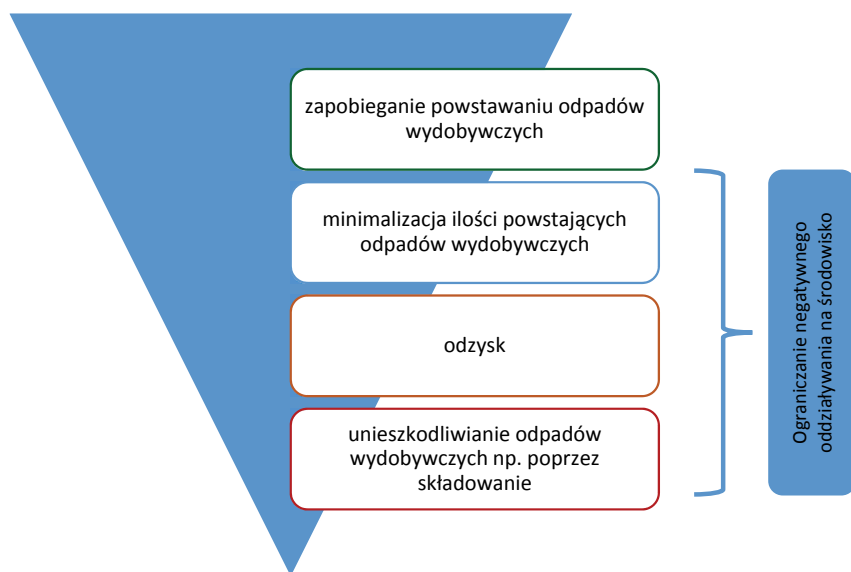
Rys. 1. Zasady postępowania z odpadami wydobywczymi Fig. 1. Rules for dealing with extractive waste
