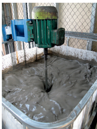
Rys. 5. Mieszanka płuczek przygotowywana do wykonania próby
