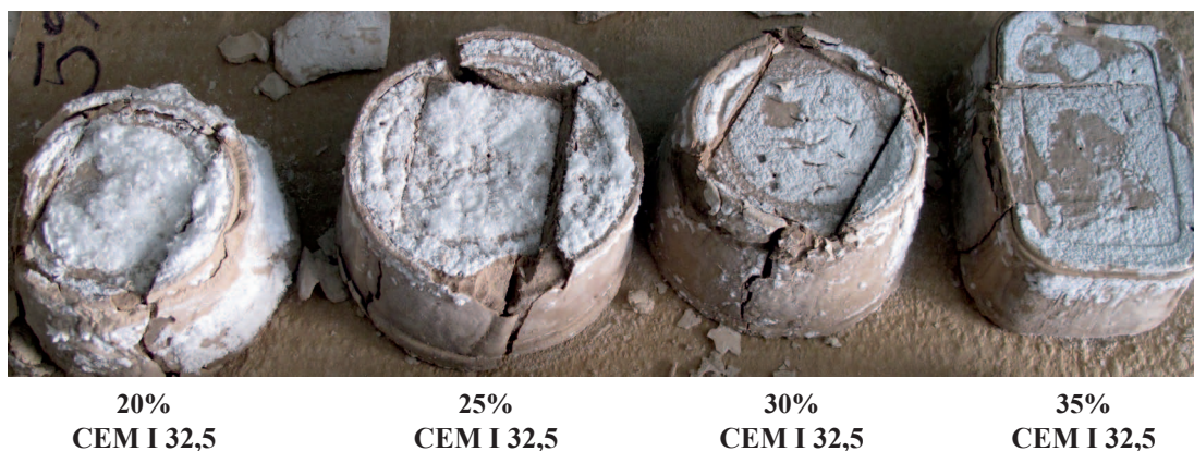
Rys. 3. Płuczka zasolona potasowo-polimerowa po zestaleniu przy użyciu 5% szkła sodowego oraz cementu portlandzkiego CEM I 32,5 w ilości 20÷35%
