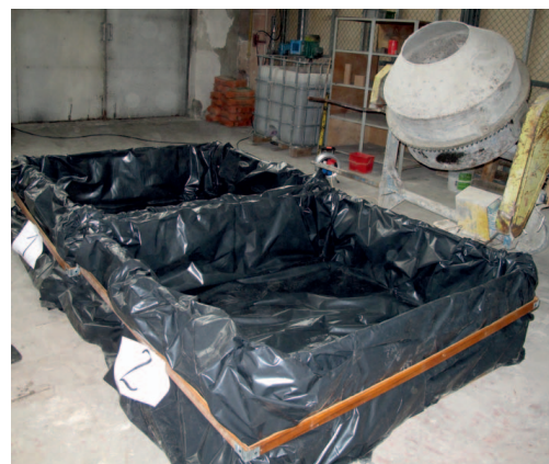
Rys. 6. Stanowisko do przeprowadzania próby zestalania płuczek otworowych
