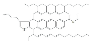
Rys. 4. Średnia struktura asfaltenu typu kontynentalnego z pozostałości z hydrokrawingu (na podstawie modeli Ancheyty i in. [4])
